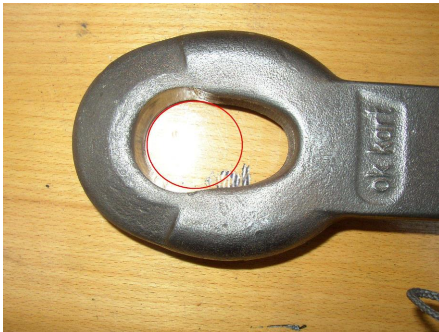
Foto č. 5 Deformácia oka ťažnej tyče po preťažení silou cca 600 kN.
