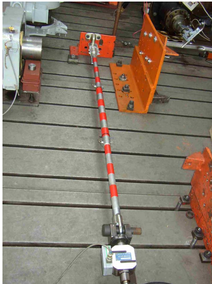
Foto č. 3 Skúška ťažnej tyče na ťah a tlak
