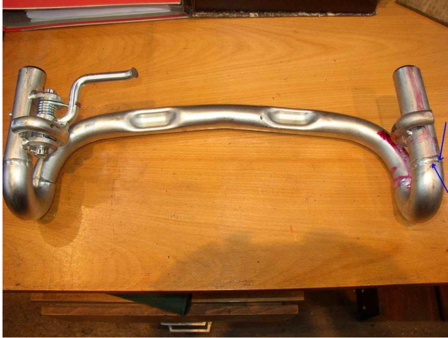
Foto č. 9 Výsledok skúšky zarážky po preťažení – zistené najslabšie miesto konštrukcie, zvar rúry – modré šípky.
