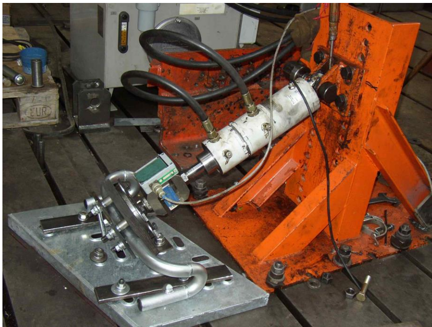
Foto č. 8 Usporiadanie skúšky zarážky. Zaťažovanie šikmou silou cez gumový segment.
