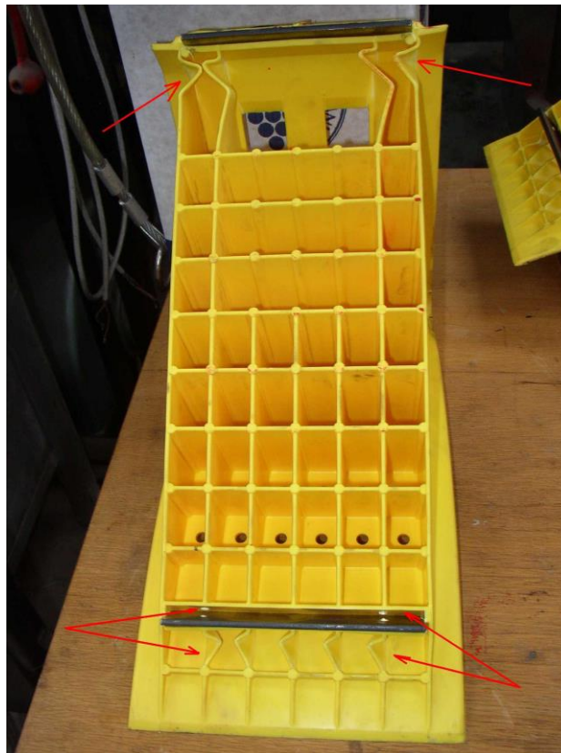
Foto č. 7 Výsledok skúšky klinu. Vytrhnutie oceľových plechov – nožov z konštrukcie klinu. Plechové nože slúžia na zarytie do podložky (asfaltu).
