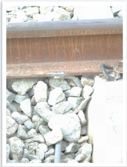
Měření teploty kolejnice
