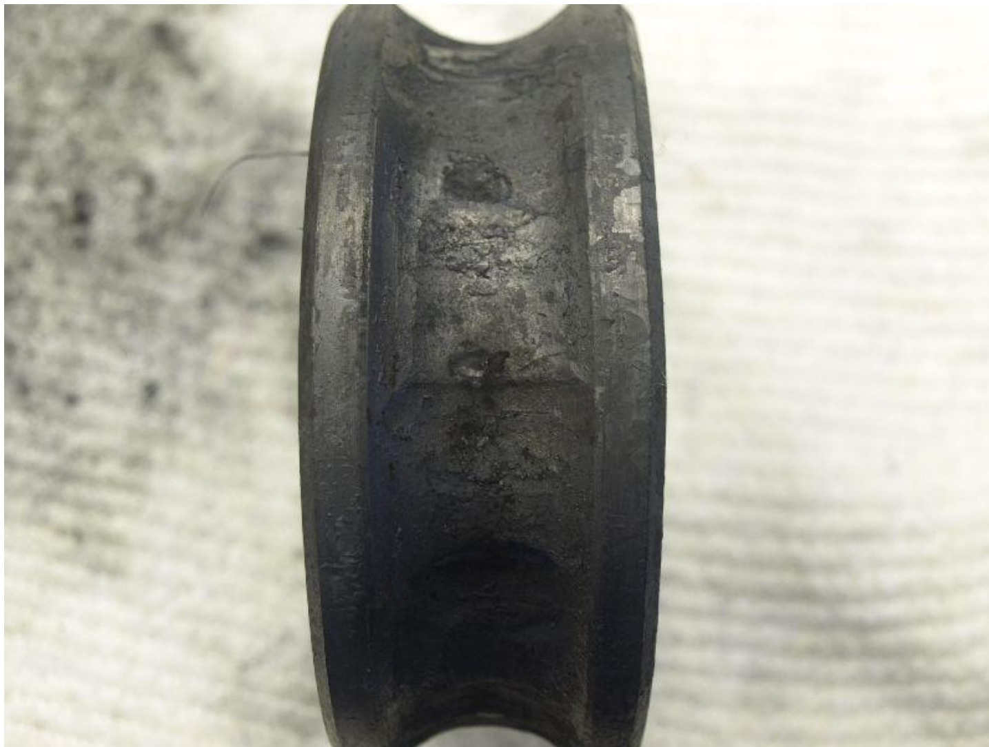
6317 C3 Ložisko A Vnitřní kroužek – oběžná dráha.
