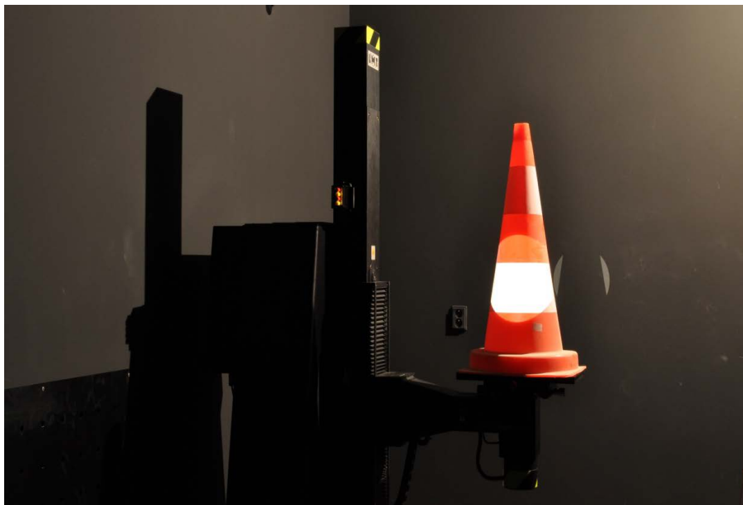
Obr. č. 4: Goniometer s dopravným kužeľom.
