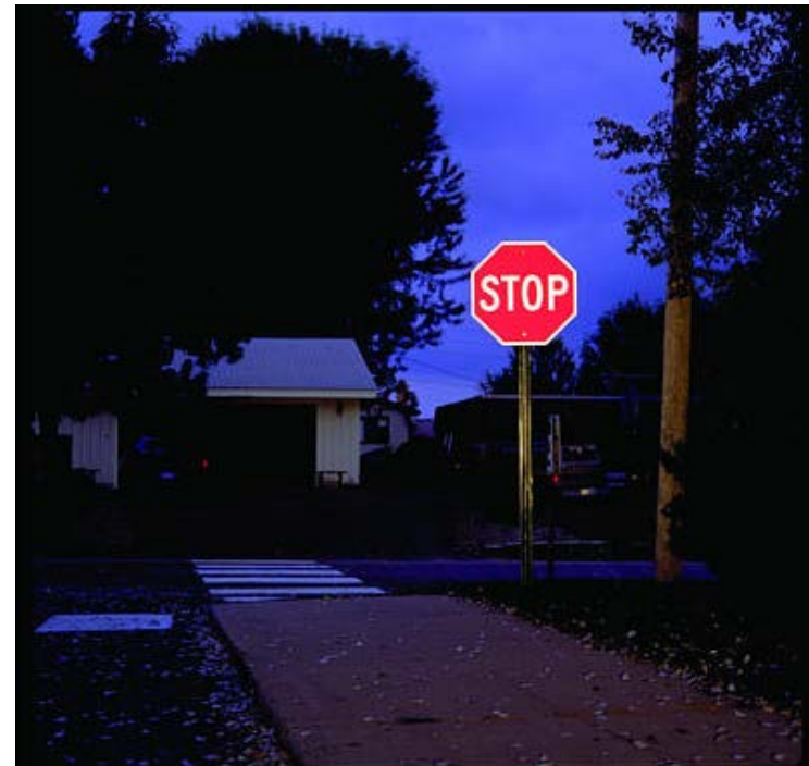
Obr. č. 2: Zobrazenie zvislej dopravnej značky STOP za nočného svetla (CIE 180:2007).
